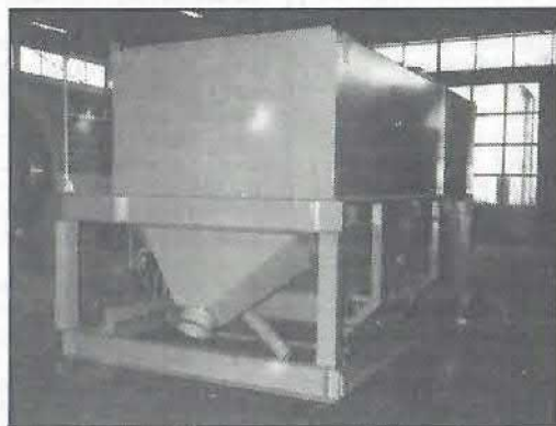
Et færdigmonteret sigte-siloanlæg
