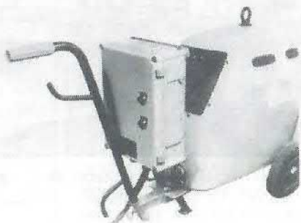
Svejseværk monteret med spændingsbegrænsende udstyr.
