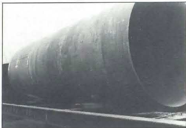
En af de mindre skorstenssektioner, diameter 2,8 m, L = 7,5 m
