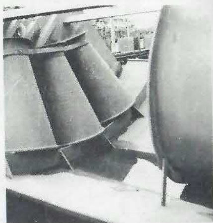
Rør og konusser for cyclonforvarmer.
